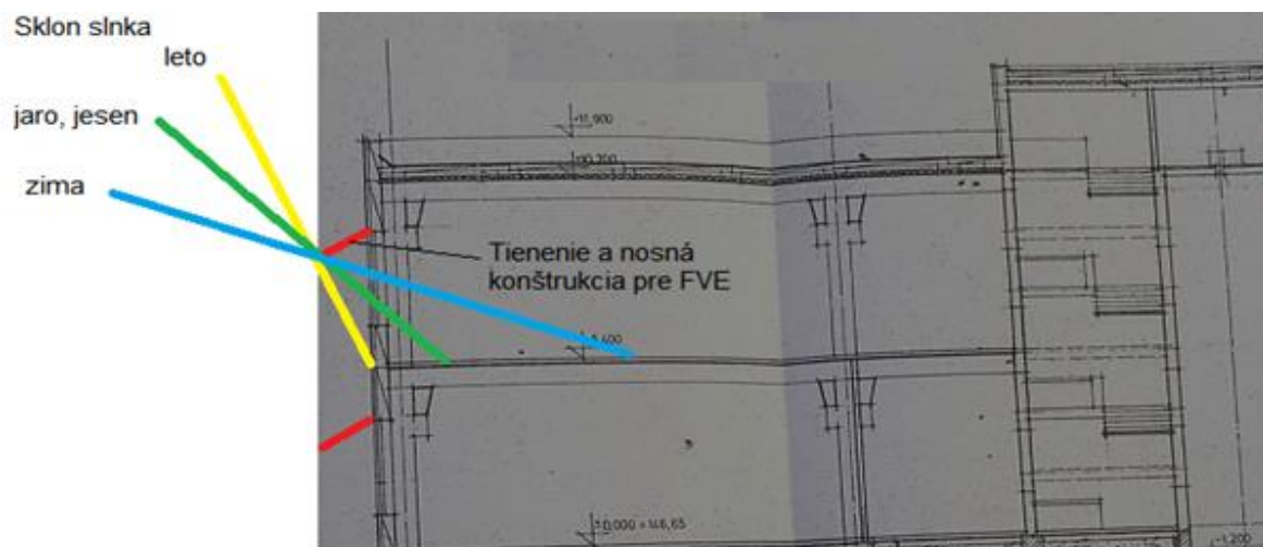
Obrázok 43: Tienenie okien a nosná konštrukcia FVE
